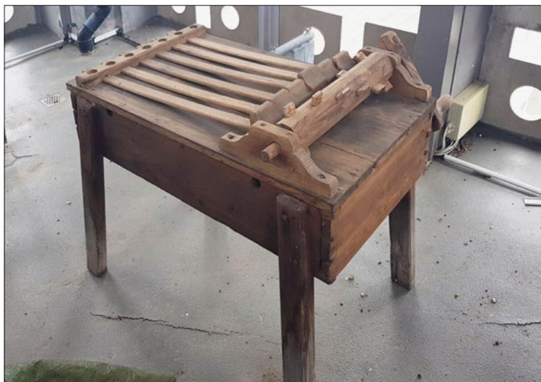
**Eine der beiden Rätschen im MaiHof-Turm. Durch Drehen der Kurbel werden die Holzhämmer angehoben, die dann auf den Resonanzkörper prallen.** Bild: Roland Feer
